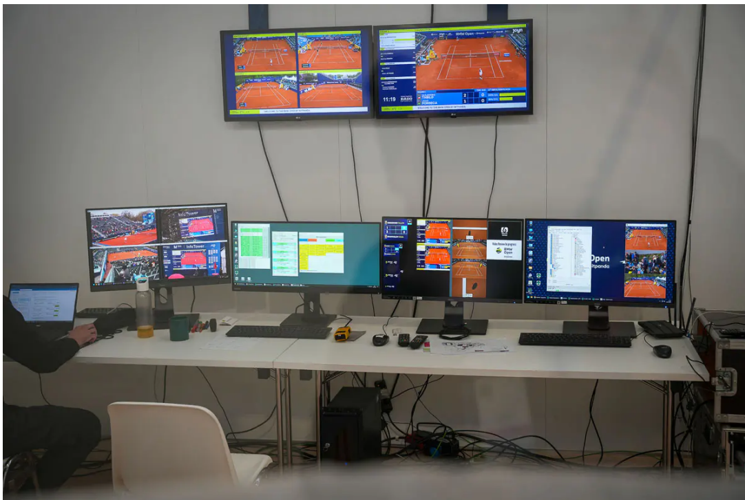
Das Electronic Line Calling von Bolt6 ersetzt die Linienrichter vollständig. In dieser zentralen Operations-Stelle laufen die Tracking-Daten aller Courts zusammen.
