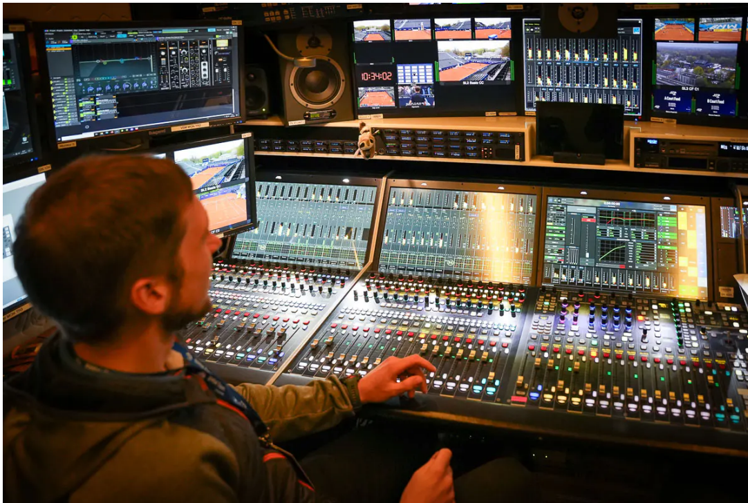
Die Tonproduktion läuft auf einem Lawo MC²56 im Ü7. Aus zwei Tonregionen entstehen zehn Audiofeeds, komplett in Stereo.
