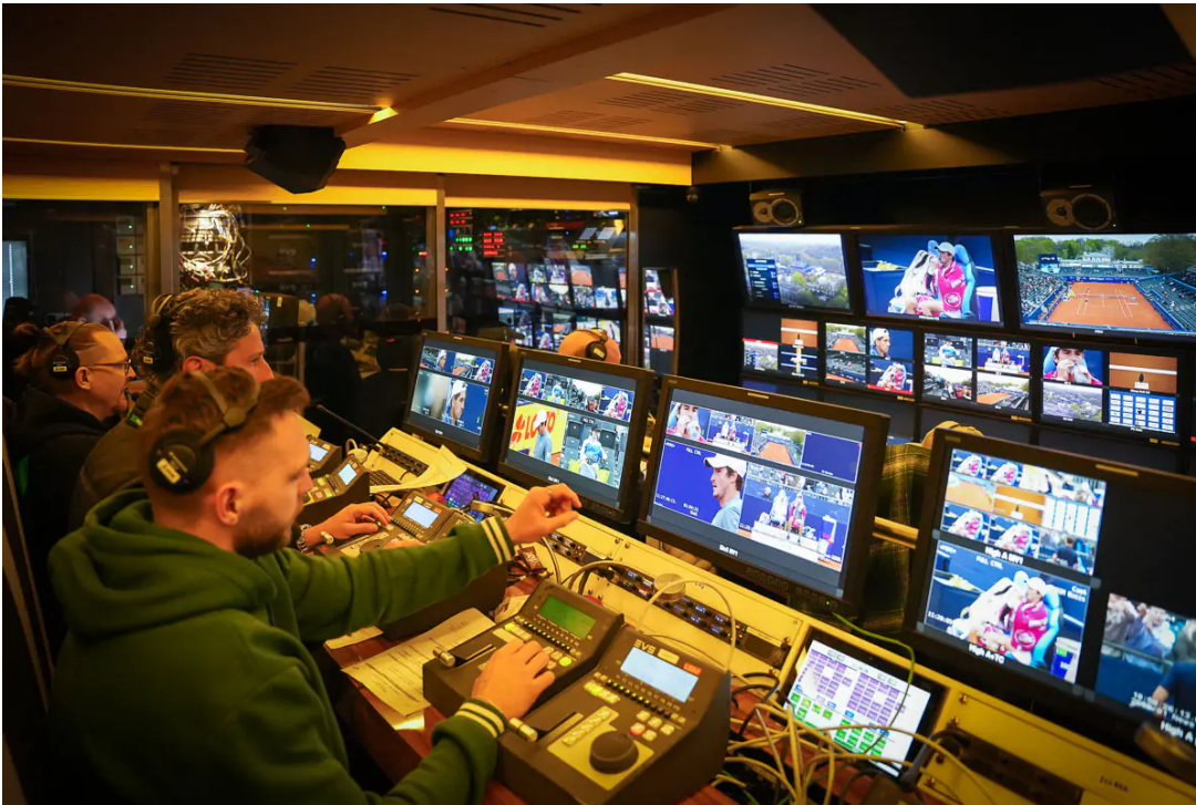
Replay-Arbeitsplätze im Ü7: Auf fünf EVS-VIA-Servern stehen 60 Kanäle für Zeitlupen und Highlights bereit.
